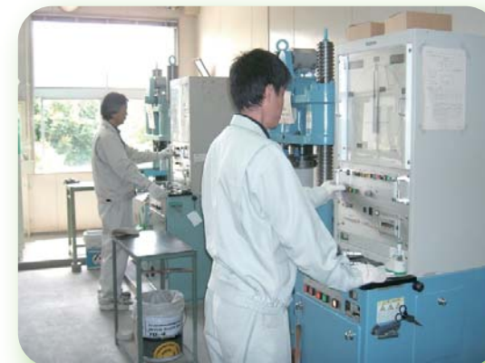
圧縮・曲げ強度試験
