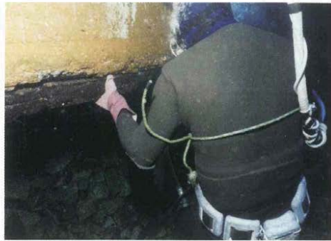
潜水土による耐久性試験用マットの採取状況
