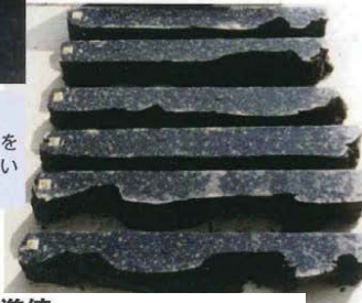
潜水土による耐久性試験用マットの採取状況
