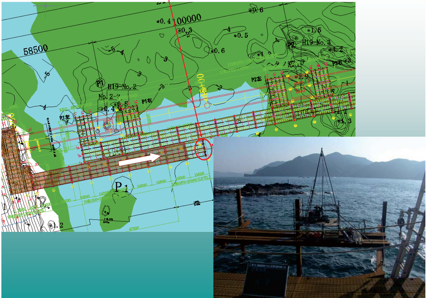
支持層の窪み (杭打込み時に確認)
