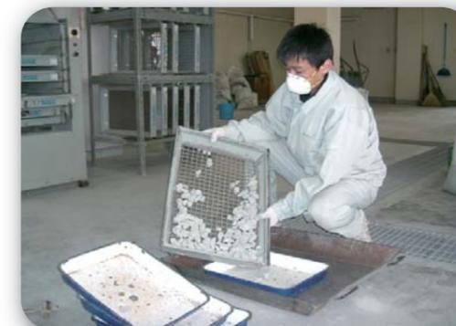
粗骨材のふるい分け試験
