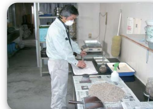
細骨材の密度試験
