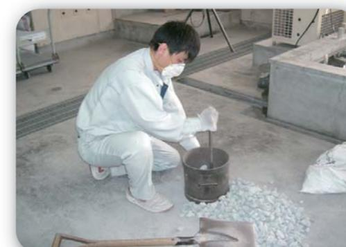
粗骨材の単位容積質量試験
