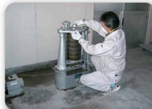
細骨材のふるい分け試験
