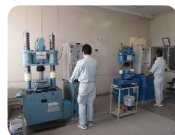
圧縮・曲げ強度試験
