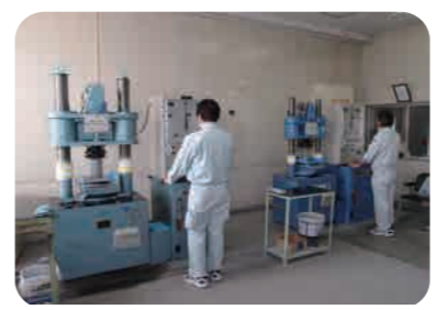
圧縮・曲げ強度試験
